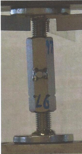
Foto 5: Mini-Stut L6, voor 2/3 deel uitgedraaid, na beproeving.
