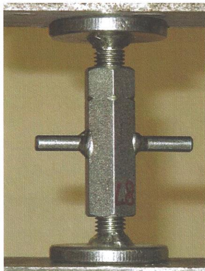
Foto 1: Afbeelding van de Mini-Stut (proefstuk, lange versie, nr. L8).
